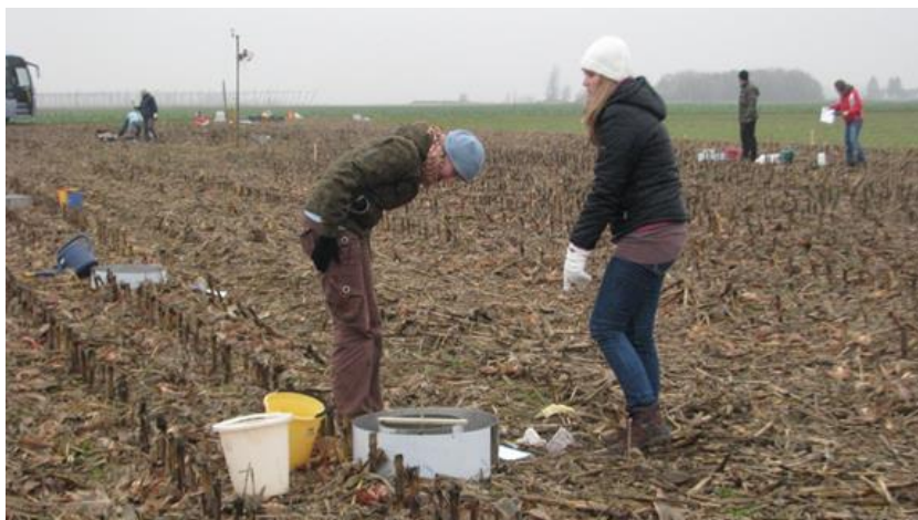
Slika 6: Prikaz meritev vodne infiltracije z uporabo cilindričnega dvojnega infiltrometra v Moškanjcih Figure 6: Water infiltration rate measurements using double ring infiltrometer at site Moškanjci
