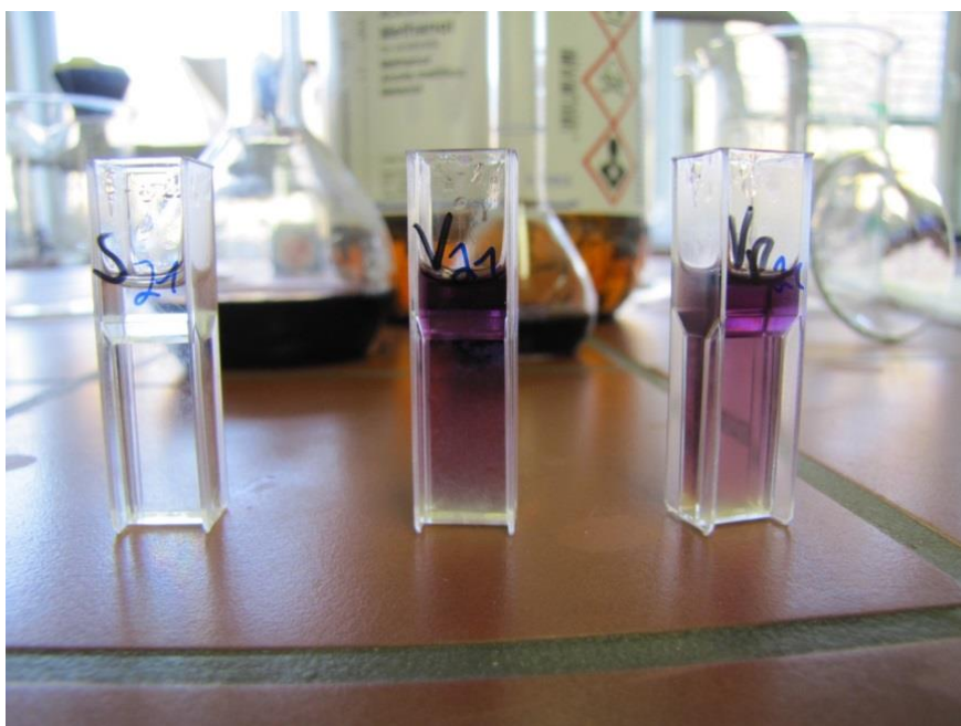
Priloga C3: Merjenje absorbance vzorca pri 517 nm. Vzorec je sestavljen iz slepega vzorca, vzorca 1 in njegove ponovitve (foto: T. Bohinc).
