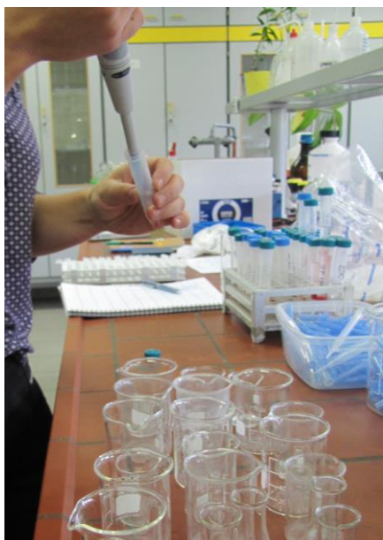
Priloga C2: Priprava vzorcev za analizo antioksidacijskega potenciala (levo) in vzorci zelja (desno), ki čakajo na merjenje absorbance pri 517 nm (foto: T. Bohinc).
