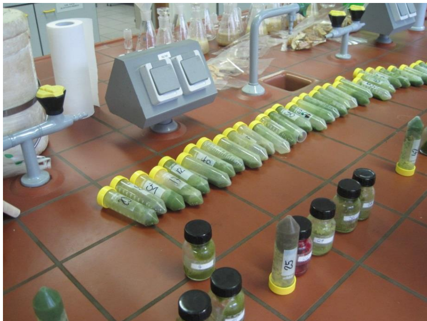
Priloga C1: Vzorci zelja namenjeni za kemične analize. 10 g svežih listov zelja smo zmešali s 4% metafosforno kislino, in vzorce shranili na -20°C (foto: T. Bohinc).
