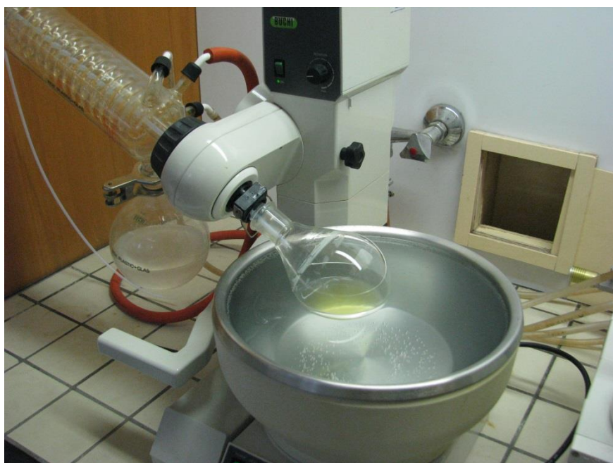
Priloga C5: Izparevanje topila pri ekstrakciji epikutikularnega voska v rotavaporju v Laboratoriju za entomologijo Oddelka za agronomijo leta 2010 (foto: J. Rupnik).
