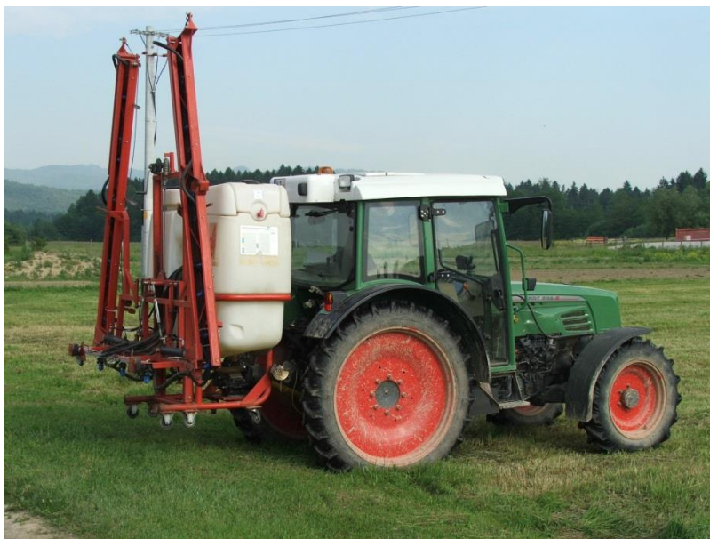
Slika 19: Traktor Fendt 208 z nošeno traktorsko škropilnico AGS 600 EN Figure 19: Fendt 308 with an AGS 600 EN tractor-mounted sprayer
