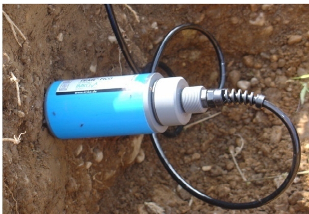
Slika 53: Merilnik za merjenje vsebnosti vode v tleh TRIME®-EZ (Dokumentacija meteorološke ..., 2013). Figure 53: Soil water content sensor measurements TRIME®-EZ (Dokumentacija meteorološke ..., 2013).
