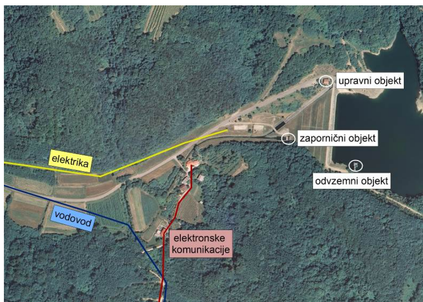
Slika 25: Prikaz vodov GJI na širšem območju pregrade zadrževalnika Vogršček (elektrika, elektronske komunikacije, vodovod). Izpis iz ZK GJI (5. 10. 2012) ne vsebuje trase vodov na pregradi zadrževalnika in neposredno ob njej (graf. podl.: DOF, 2010; ZK GJI, 2012).
