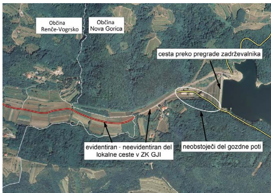
Slika 24: Prikaz prometne infrastrukture – cestnega omrežja iz ZK GJI. V ZK GJI ni opredeljena povezovalna pot preko pregrade, del gozdne poti na levem boku pregrade ne ustreza dejanskemu stanju v naravi. V ZK GJI je na desnem boku pregrade vrisan le del dostopne poti, ki pripada Občini Renče-Vogrsko, del, ki pripada Občini Nova Gorica, ni evidentiran (graf. podl.: DOF, 2010; ZK GJI, 2012).
