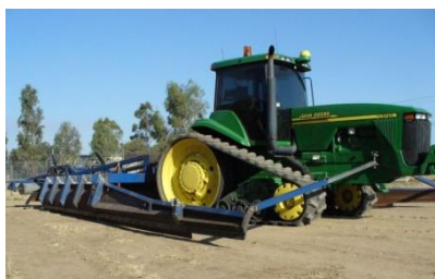
Slika 9: Dvoosni traktor z gumijastimi gosenicami (Medpodjetniški ..., 2012)
