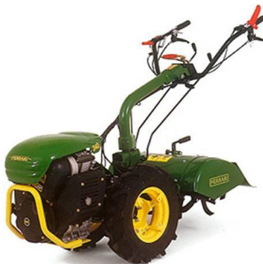
Slika 4: Enoosni traktor: motorni prekopalnik (Glušič, 2010)
