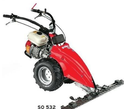
Slika 6: Enoosni traktor: strižna kosilnica (Glušič, 2010)
