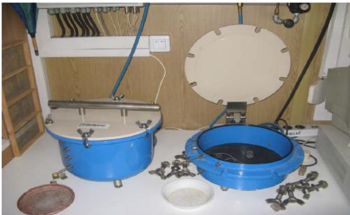
Slika 17 : Visokotlačna komora (Richardova posoda) za določevanje vodno-retenzijskih lastnosti talnih vzorcev
