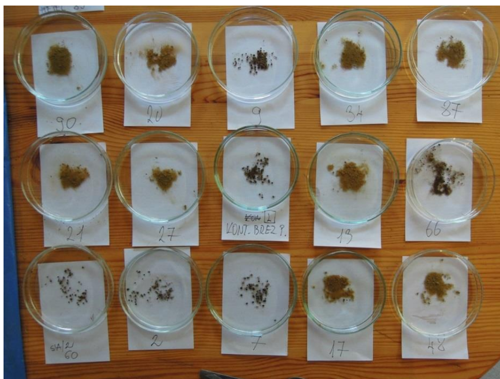
Slika 19 : Test obstojnosti strukturnih agregatov z metodo po Sekeri
