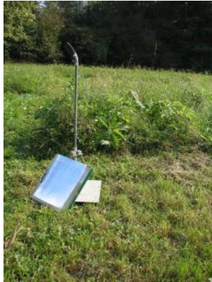
Slika 8: Višina ruše je bila izmerjena z mehanskim višinomerom in deleži funkcionalnih skupin so bili določeni z ročnim prebiranjem (foto: M. Vidrih)
