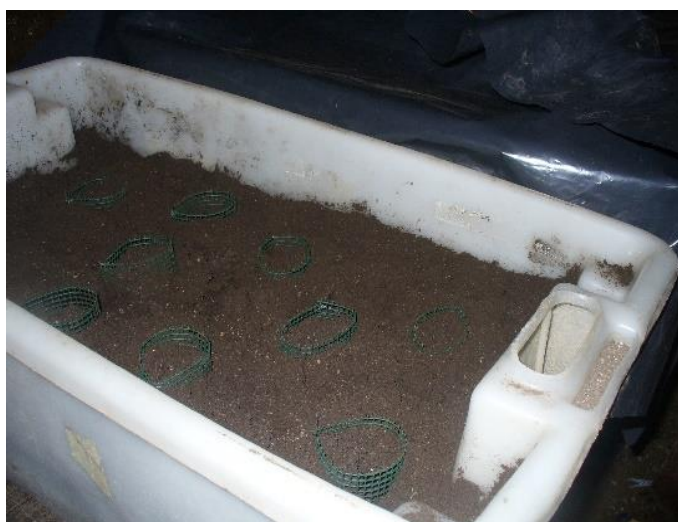
Slika 6: Posoda z onesnaženimi tlemi in z 10 mrežastimi kolonami z remediiranimi tlemi
