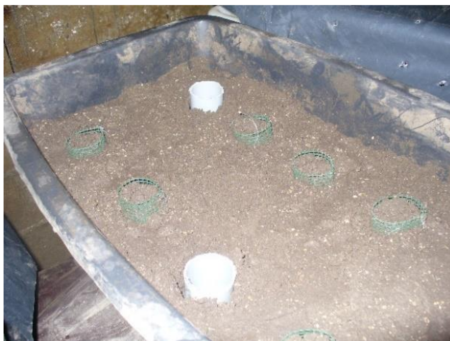
Slika 7: Med poskusom smo odstranjevali mrežaste kolone, analizirali remediirana tla in jih nadomestili s plastičnimi tulci.
