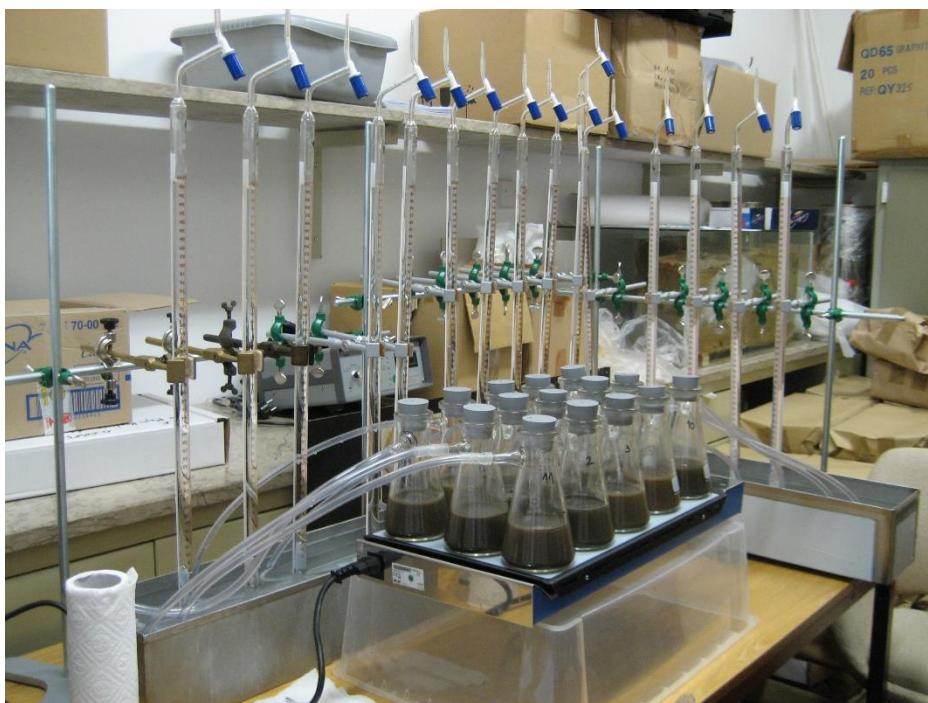
Slika 7: Laboratorijska aparatura za pridobivanje bioplina (foto: Jarc A., 2010).
