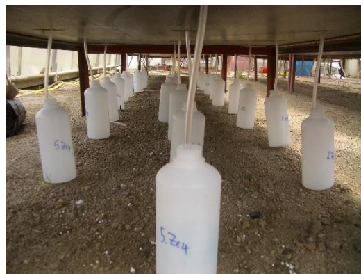
Slika 3-levo: Sadilni lonec z drenažno odprtino, (2004). Slika 4-desno: Drenažne cevke in plastenke za lovljenje odcedkov, (2004)
