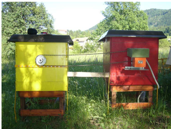
Slika 8: Motor in verižni prenos za obračanje bobnov v testnih panjih
