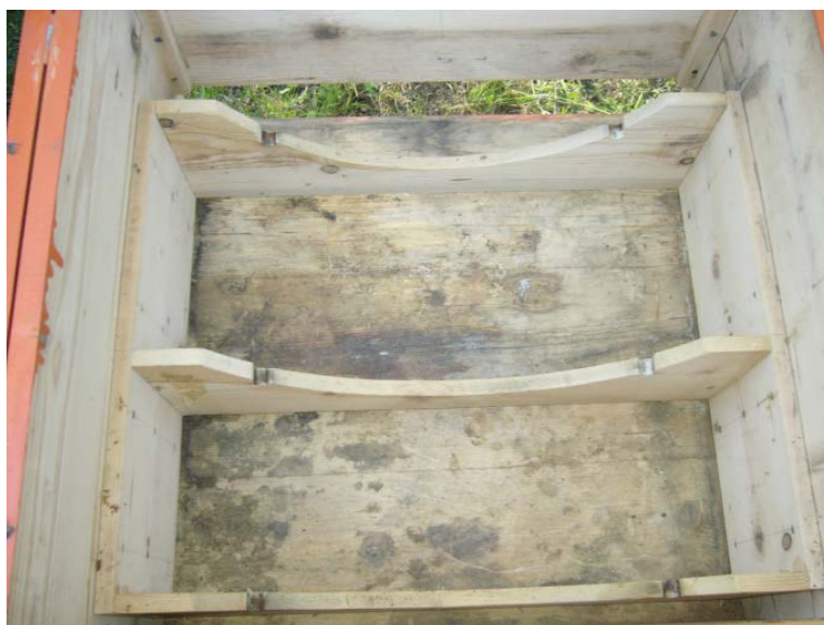
Slika 12: Nosilno ogrodje bobna
