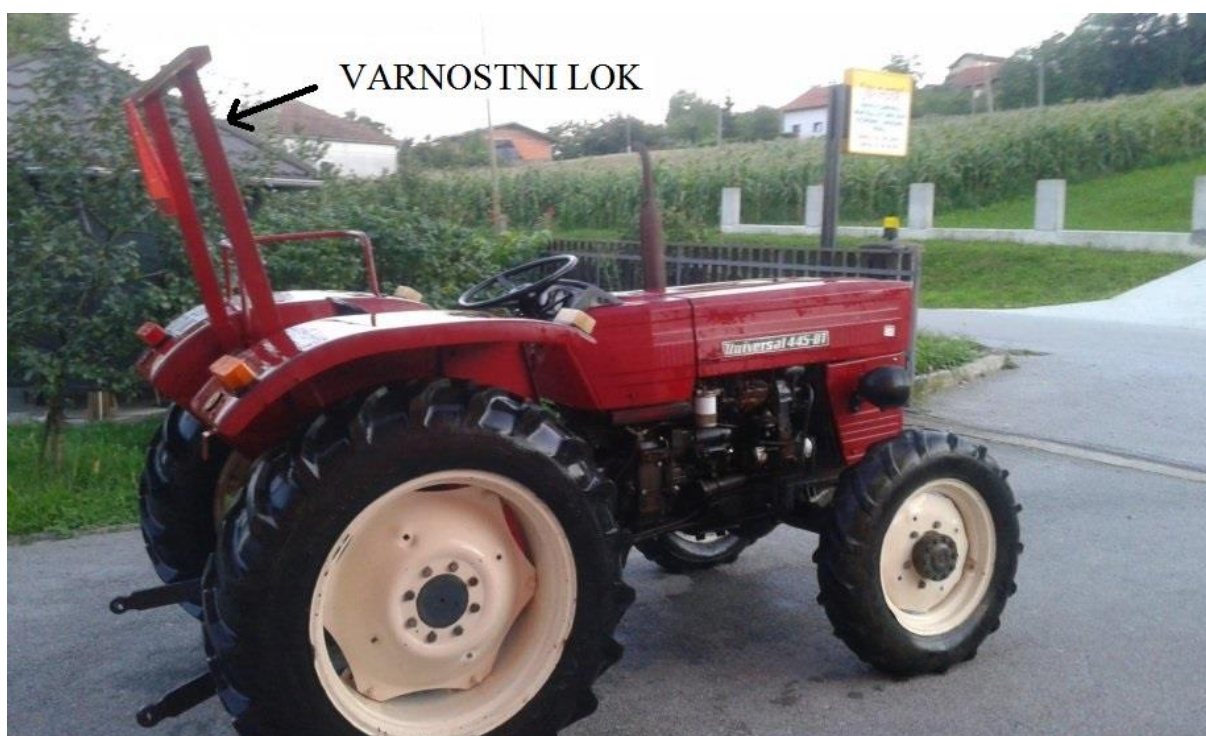
Slika 16: Standardni traktor Univerzal 445 DTC z varnostnim lokom (foto: Žiga Kršinar)
