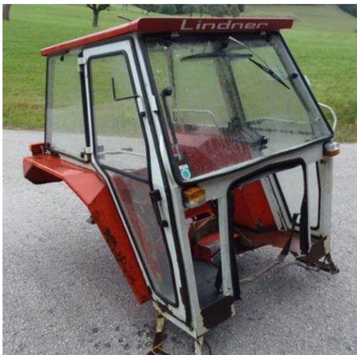
Slika 19: Varnostna kabina standardnega traktorja (Landwirt ..., 2016)
