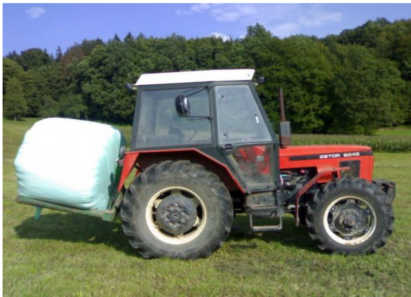
Slika 18: Standardni traktor Zetor 6245 z vilicami za prenos bale in silažno balo (Vozni park ..., 2007)
