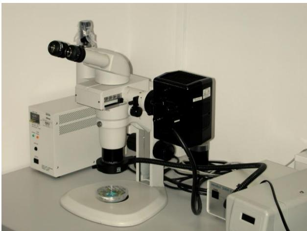
Slika 7: Epifluorescentni mikroskop z ustreznim setom filtrov za spremjanje gfp proteina
