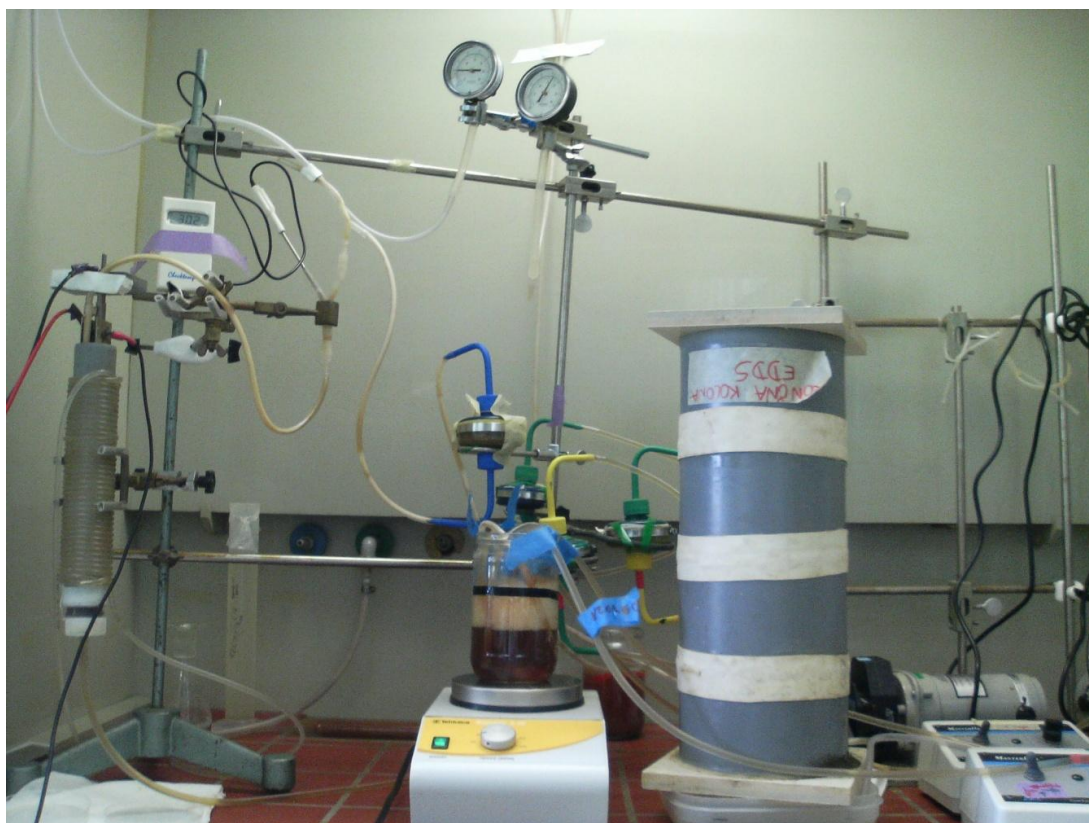
Slika 2: Prikaz remediacije tal z uporabo EDTA za ekstrakcijo težkih kovin s pomočjo BDDA.
