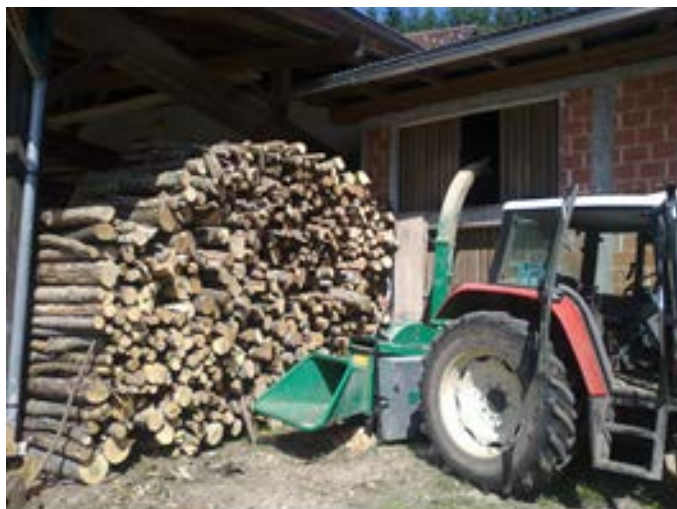
Slika 8: Sekalnik, ki melje les neposredno (direktno) v zalogovnik za sekance
