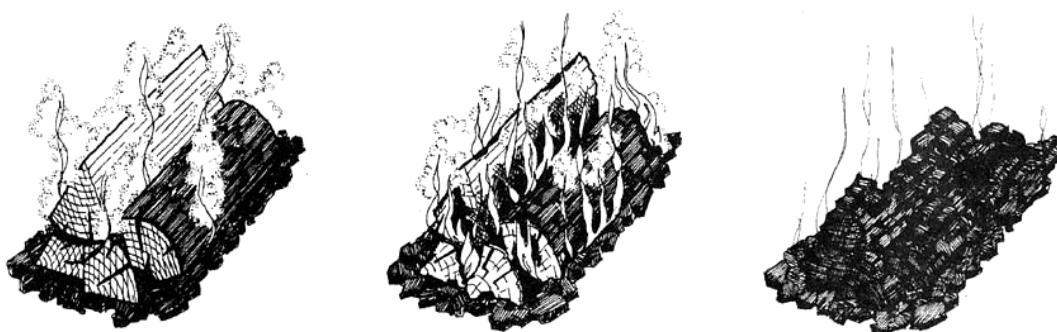
Slika 5: Tri stopnje zgorevanja lesne biomase: segrevanje, sušenje in piroliza (levo), oksidacija plinov (sredina), oksidacija oglja (desno) (Butala in Turk, 1998:12).
