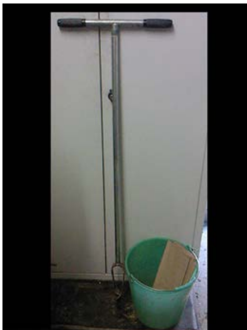
Slika 3: Pribor za odvzem vzorcev tal v rastlinjakih (sveder, vedro, papirnate vrečke, nož, rokavice)
