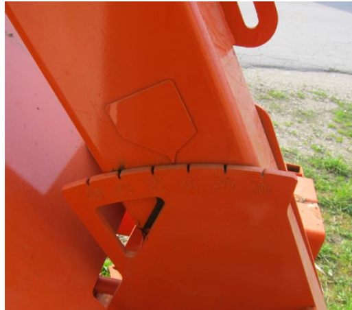
Slika 9: Nastavitev kota noža; Zagaj, 2014 (foto: Hudina, 2014)
