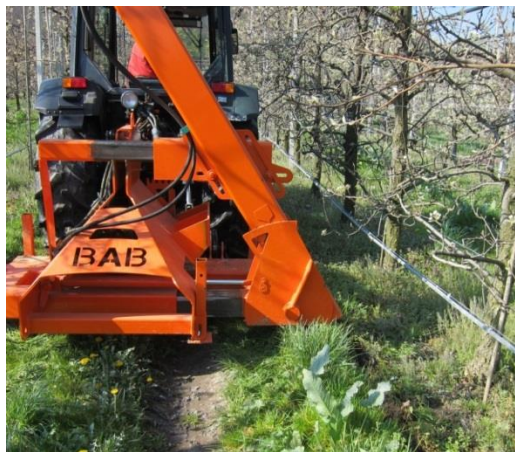
Slika 8: Izvedba strojne rezi korenin; Zagaj, 2014 (foto: Hudina, 2014)
