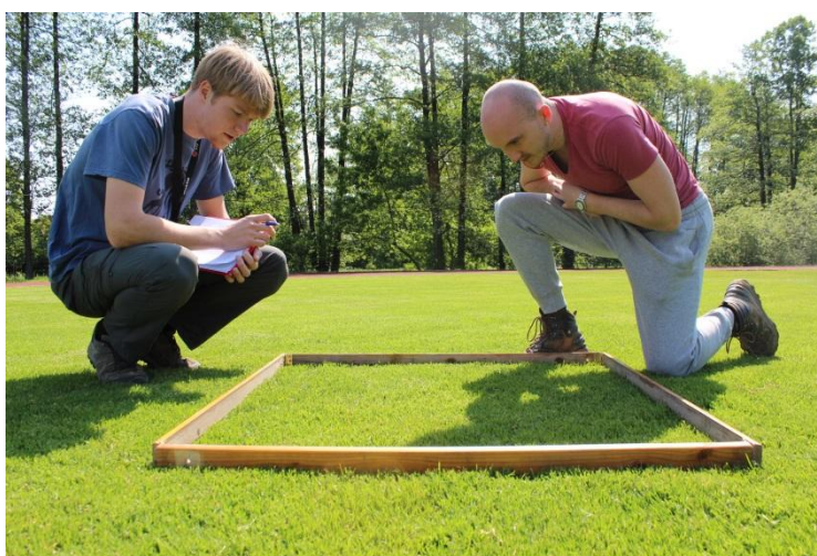
Slika 2: Ocenjevanje pokrovnosti tal s pomočjo lesenega okvirja s površino 1 m x 1 m (foto: Trdan S., 2015).
