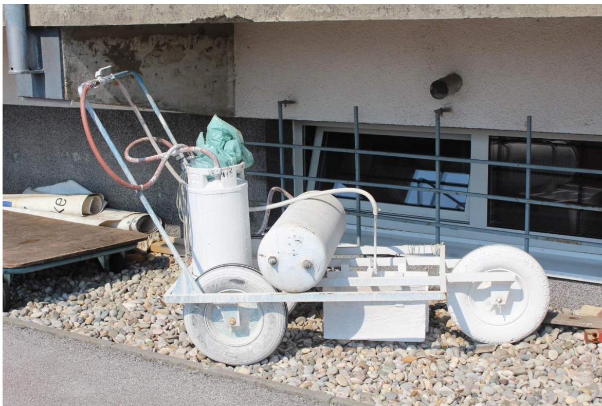
Naprava za risanje označevalnih črt na stadionu na Ptujju (foto: S. Trdan).
