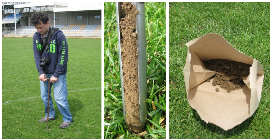
Slika 4: Odvzem talnih vzorcev s sondo (foto: Rupnik J.).
