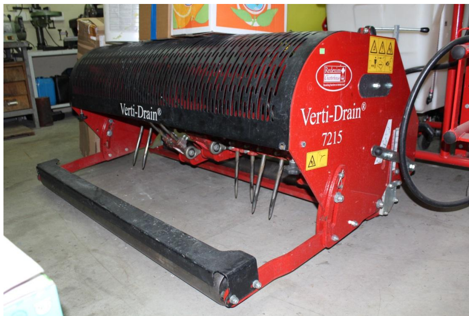
Priključek za globoko zračenje travne ruše v garaži Javnega zavoda za šport Ptuj (foto: S. Trdan)
