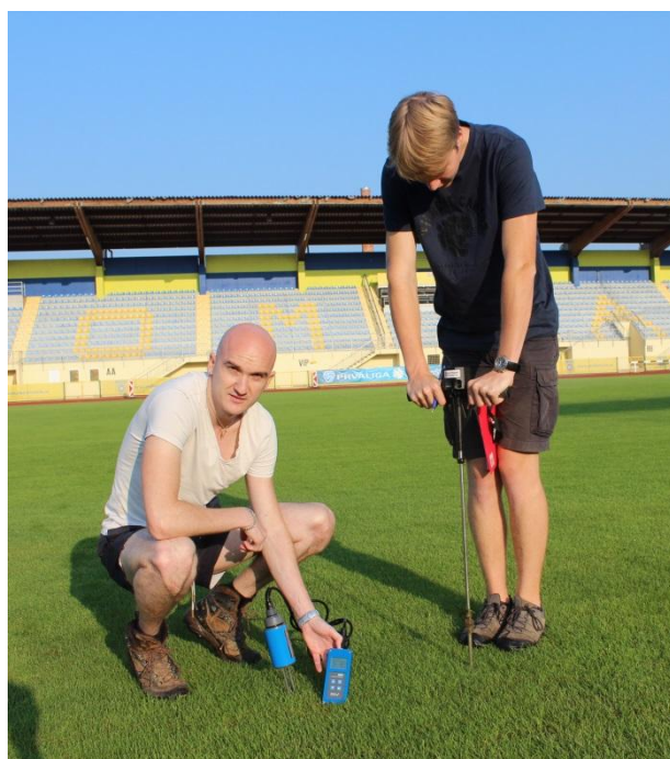
Slika 3: Merjenje zbitosti tal in količine vode v tleh (foto: Trdan S., 2015)
