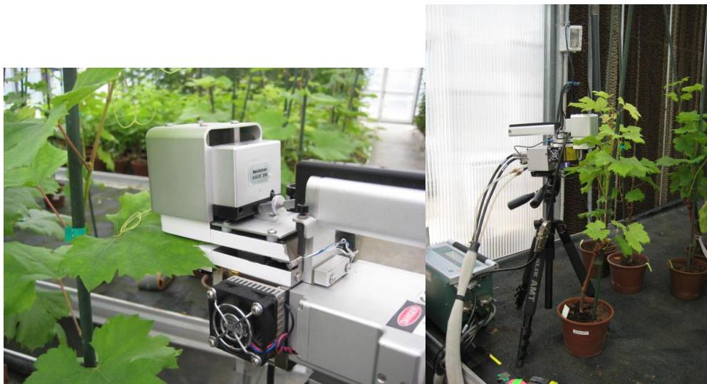
Slika 5: Meritve fotosintezne aktivnosti z aparaturom Licor 6400xt(foto: Kodre, 2013)
