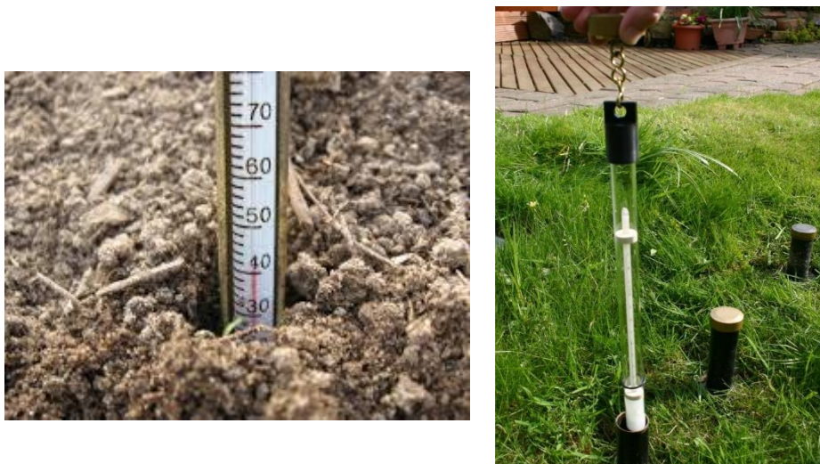
Slika 17: Različni termometri za meritve tal (levo; Five ..., 2015, desno; More ..., 2015).
