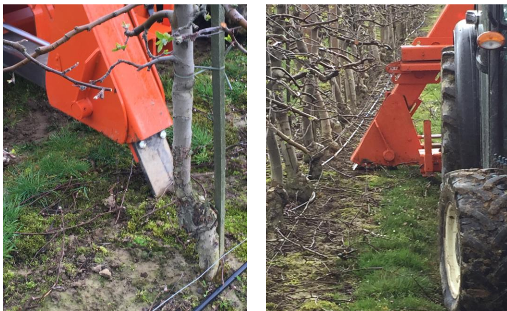
Slika 5: Stroj za rez korenin z odmikom 40 cm od debla; Bistrica ob Sotli, 2014 (foto: N. Kovačič, 2014)
