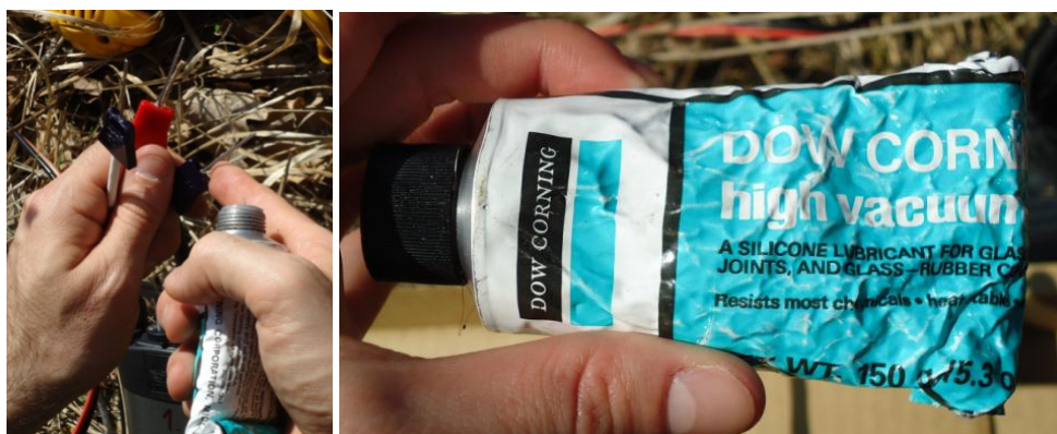
Slika 11: Merilne igle smo premazali s posebno silikonsko mastjo
