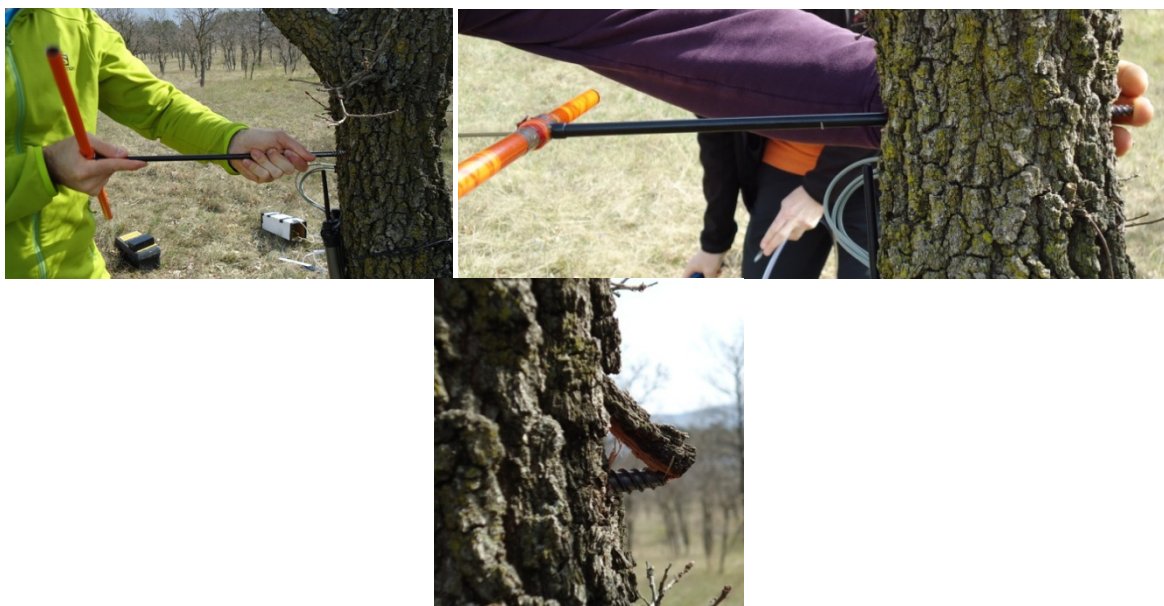
Slika 15: Vrtanje izvrtkov skozi deblo s Presslerjevim svedrom
