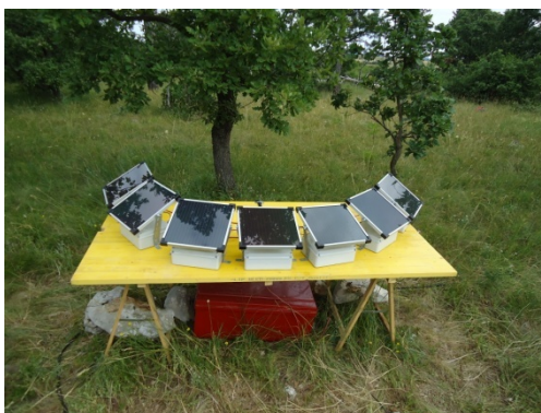
Slika 14: Postavitev skupnega napajanja električne energije za oskrbo baterij merilnikov ksilemskega toka
