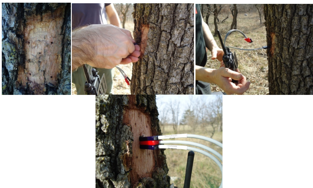
Slika 12: Merilne igle smo namestili v izvrtane luknje
