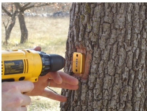
Slika 10: Vrtanje lukenj skozi šablono v beljavo debla
