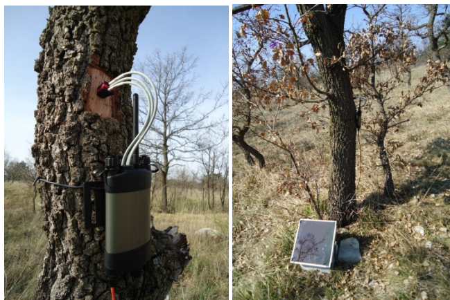
Slika 13: Namestitev merilnika ksilemskega toka in solarne celice
