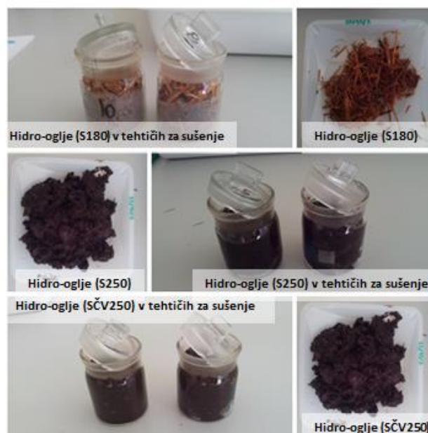
Slika 10: Določanje suhe snovi v vzorcih hidro-ogljja
