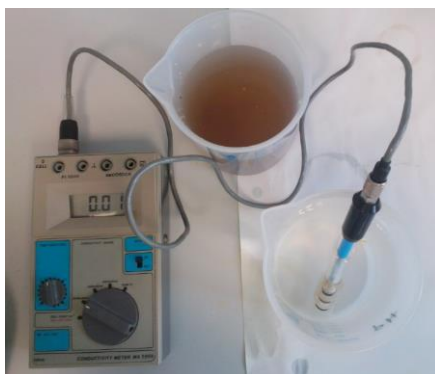
Slika 9: Naprava za merjenje elektroprevodnosti konduktometer ISKRA MA 5966
