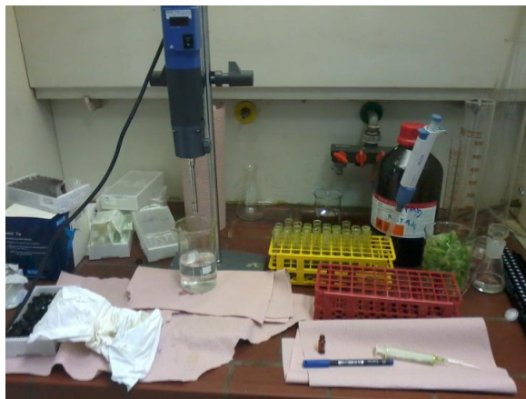
Slika 11: Homogenizator Ultra-turrax (Janke & Kunkel GmbH & Co. KG) in ostali pripomočki za pripravo vzorcev za HPLC (Novak, 2013).
