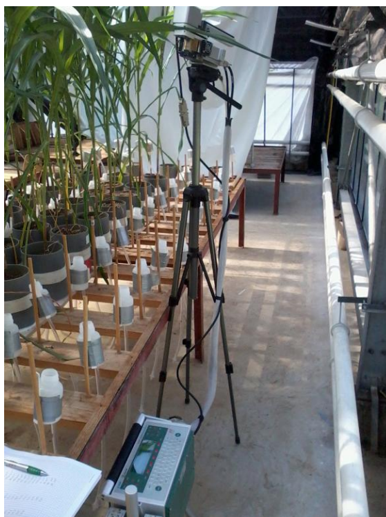
Slika 7: Prenosni merilni sistem LiCor-6400 (foto: Novak)
