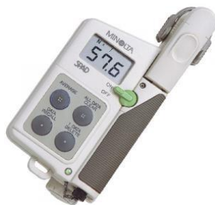
Slika 6: Klorofilmetar SPAD-502 (Minolta) (ENVCO, 2013)
