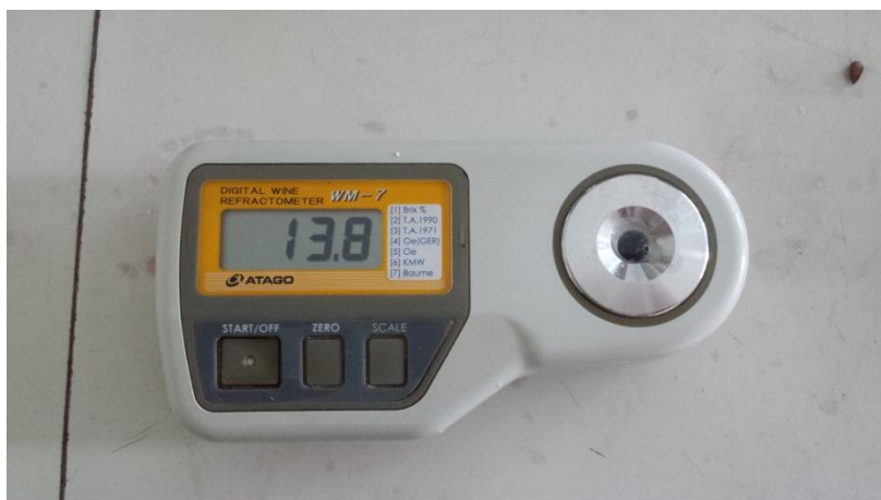
Slika 6: Refraktometer za merjenje vsebnosti topne suhe snovi plodov jablane križanca 'GJZ'
