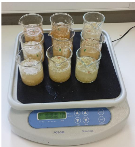
Slika 8: Pripravljeni ekstrakti za analizo primarnih metabolitov (organske kisline in sladkorje) na stresalniku
