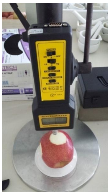
Slika 4: Penetrometer za merjene trdote mesa
