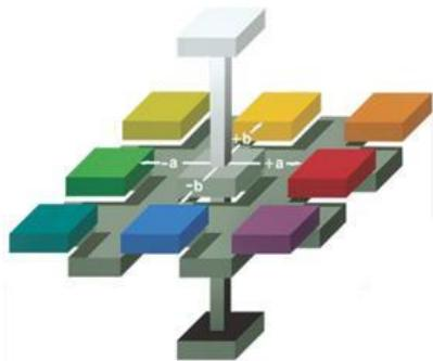
Slika 3: Barvni spekter s parametri L\*, a\* in b\* (Hunter lab color scale, 1996)
