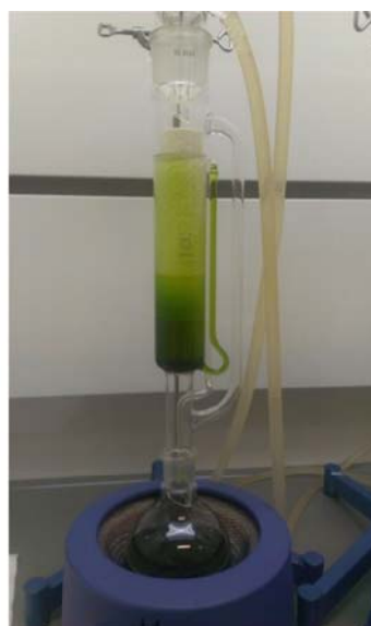
Slika 4: Shematski prikaz Soxhletovega aparata (prirejeno po Soxhlet extractor ..., 2015) (levo) in potek ekstrakcije žajblja ( Salvia officinalis L.) s Soxhletovim aparatom (foto: Svetlin, 2014)
