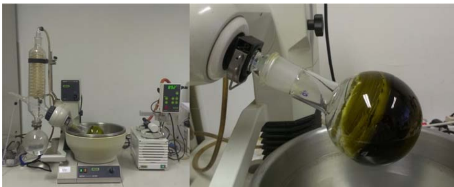
Slika 5: Uparjanje topila z rotacijskim vakuumskim uparjevalnikom (rotavapor Büchi) (foto: Svetlin, 2014)
