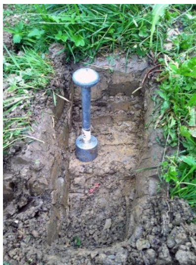
Slika 7: Slika vzorjenja tal s Kopeckijevim cilindrom (foto: Zala Zorenj)
