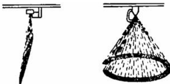
Slika 10: Pahljačasti curek odbojne šobe (Novak in Maček, 1990)
