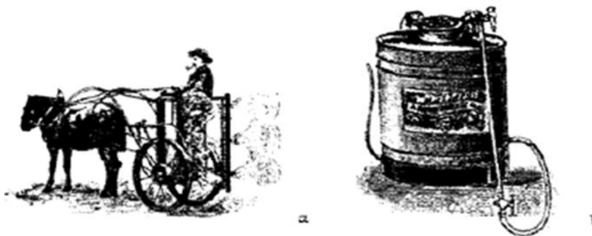
Slika 2: a) vprežna vinogradniška škropilnica iz leta 1890, pogon na lastna kolesa, b) nahrbtnna klasična škropilnica iz leta 1905
