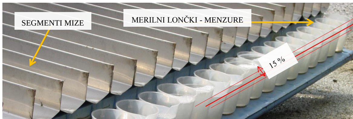
Slika 18: Testirna miza z merilnimi lončki za ugotavljanje prečne porazdelitve škropiva (foto: U. Golorej)
