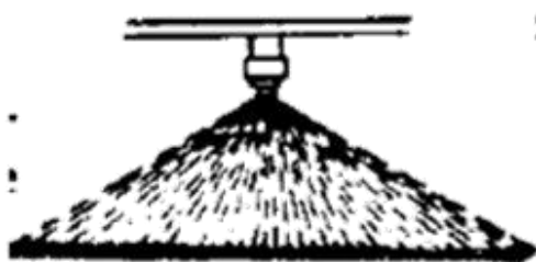
Slika 12: Sploščen curek špranjaste šobe (Novak in Maček, 1990)
