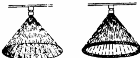
Slika 8: Stožčasti poln curek in votel curek vrtinčne šobe (Novak in Maček, 1990)
