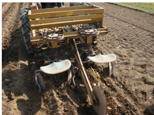
Slika 17: Sajenje s polavtomatskim (vlagalnim) sadilnikom
