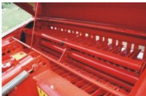
Slika 6: Rotacijska potisna naprava (SIP, 2014/2015)
