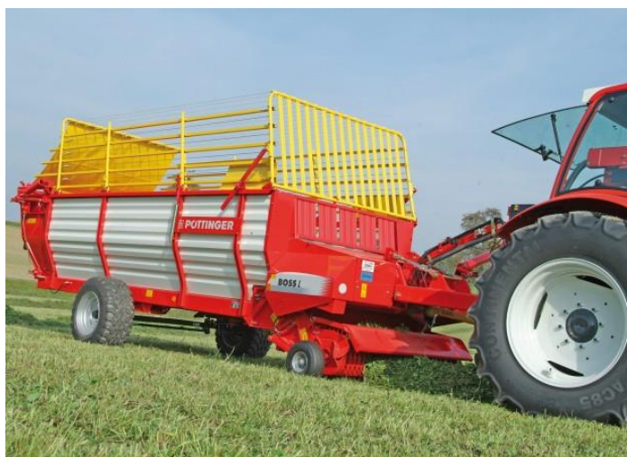
Slika 1: Samonakladalka z nižjem težiščem za hribovit teren (Zupan - trade, 2015)
