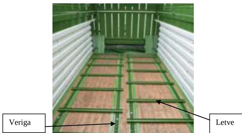
Slika 10: Letveni transporter z 4 verigami (Mehanizacija Miler, 2015)
