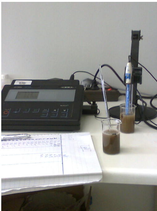
Slika 5: Merjenje pH tal v laboratoriju. Izbrane zmlate vzorce smo dobro premešali v raztopini \text{CaCl}_2 in izmerili vrednost pH ter zapisali rezultate.
