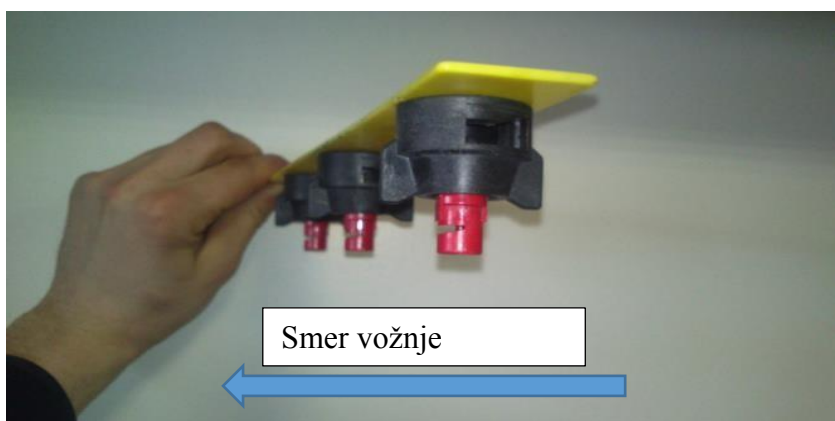
Slika 5: Postavitev šob naprej glede na smer vožnje (curek naprej) (foto: Pelc, 2015)
