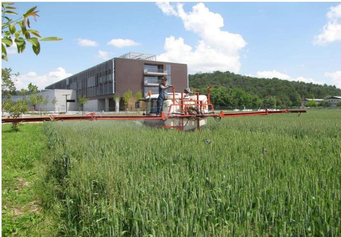
Slika 14: Izvedba škropljenja s škropilnico AGS 600 EN in traktorjem Fendt 208 S (foto: Pelc, 2015)
