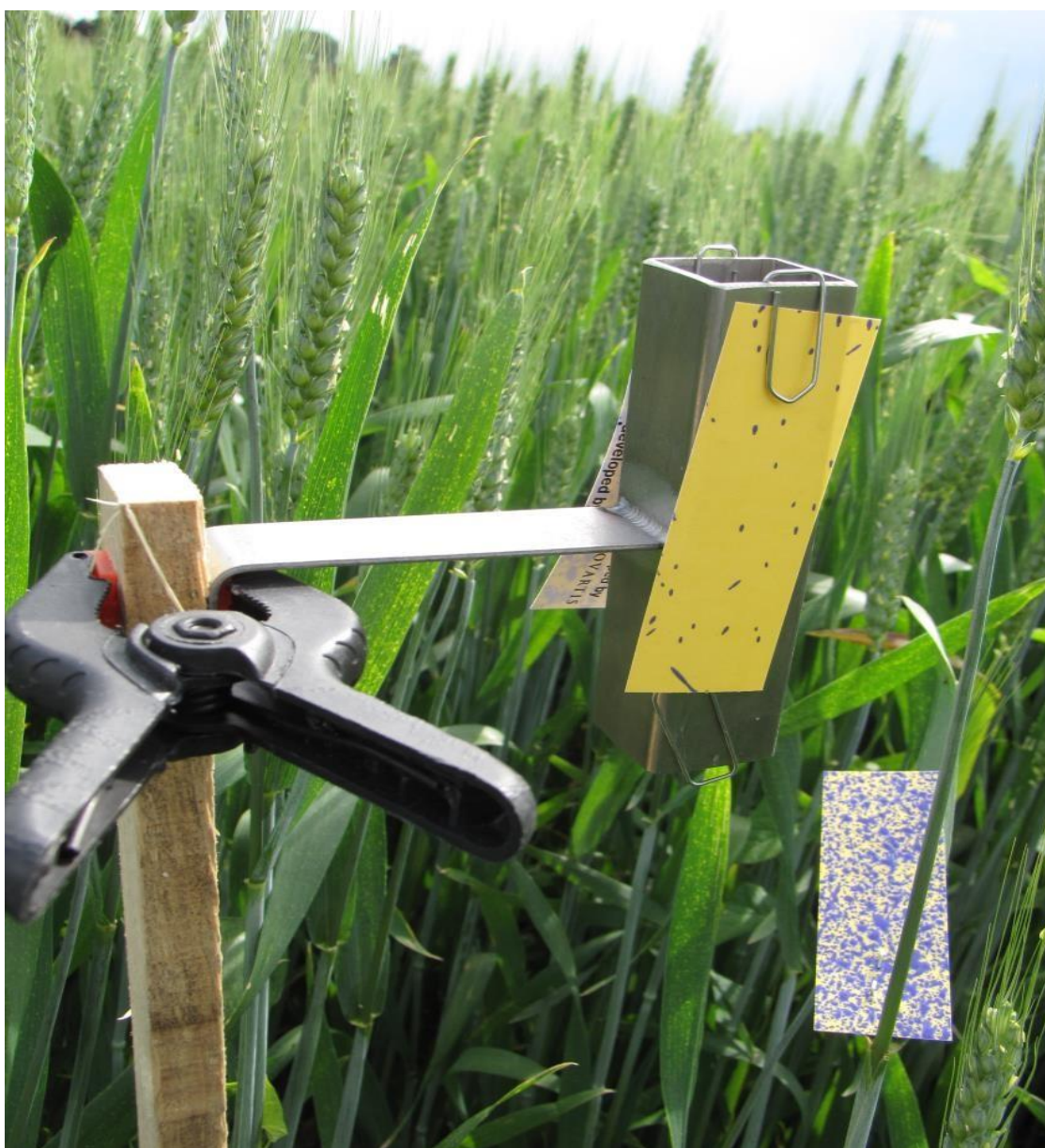
Slika 11: Namestitev na vodo občutljivih lističev (WSP) na klas (foto: Pelc, 2015)
