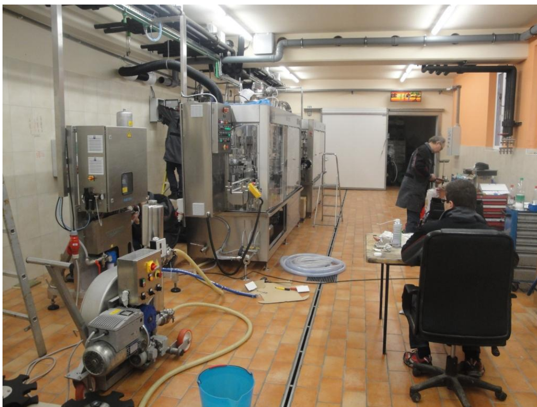
Slika 6: Vzpostavitev delovanja polnilne linije (foto: Prus, 2012)
