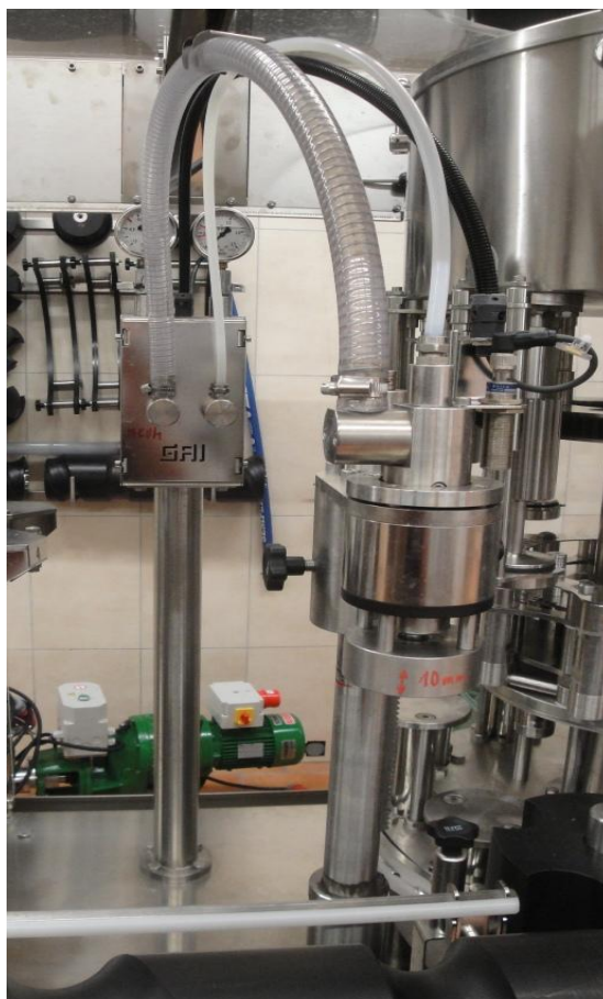
Slika 8: Vakuumska črpalka za odplinjevanje atmosferskega zraka iz steklenice (foto: Prus, 2012)
