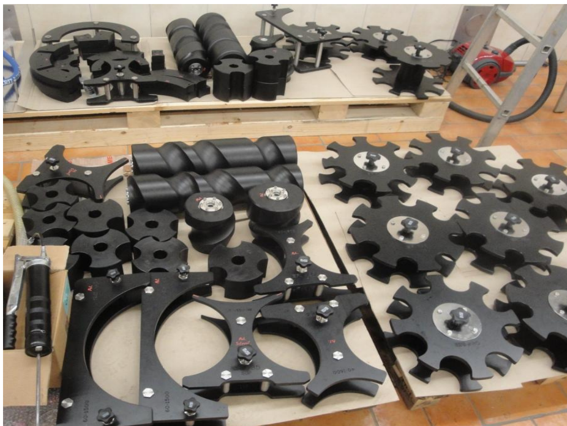
Slika 25: Zvezde, pozicijski valji in ščitni oboki obeh monoblokov (foto: Prus, 2012)
