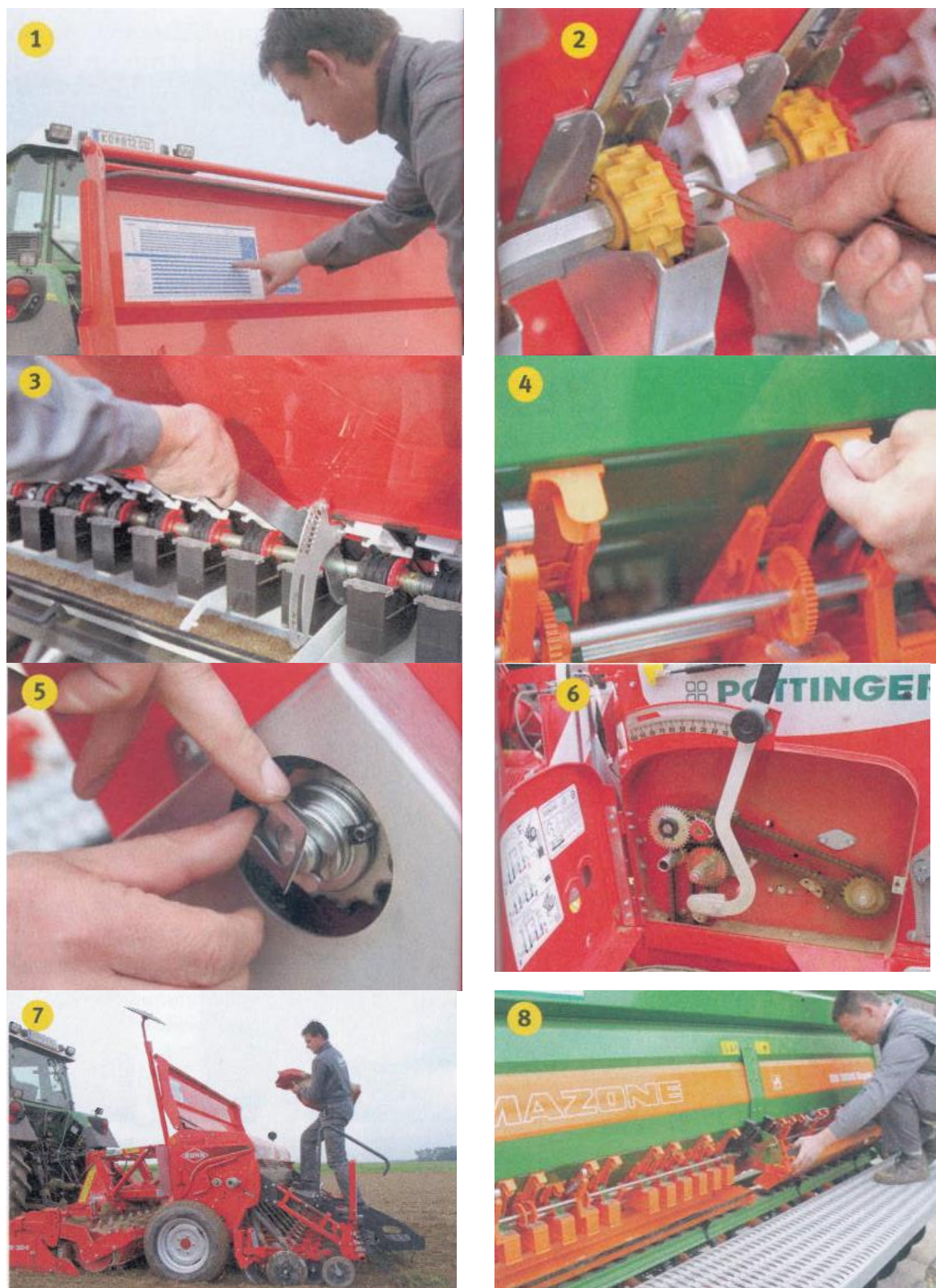
Slika 6: Nastavitev količine semena pri mehanski sejalnici za strnjeno setev po korakih 1–8 (Böck, 2015).
