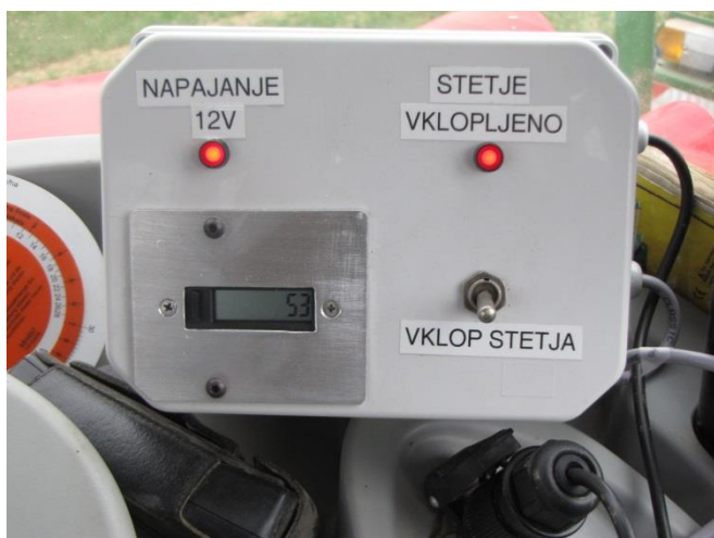
Slika 15: Merilna naprava v traktorju.
