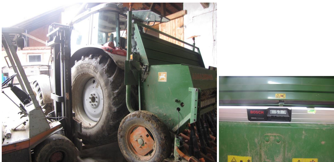
Slika 8: Dvignjen traktor in mehanska sejalnica pri poskusu za 10 % v desno (5,7°).
