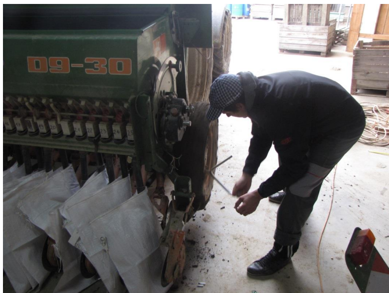
Slika 9: Meritev prečne porazdelitve mase semena po posameznih sejlnih cevih pri ozimni pšenici.
