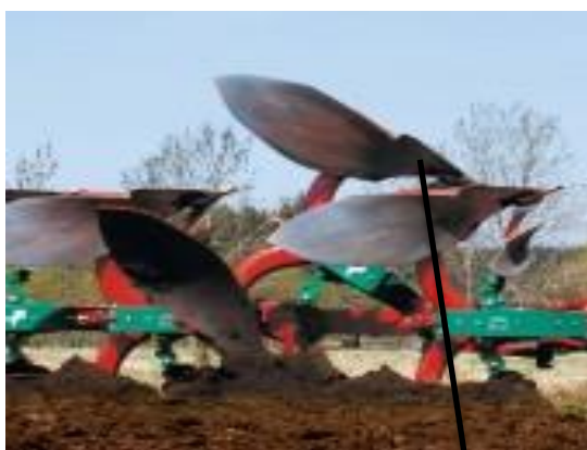
Varovanje pri naletu na oviro (dvig plužnega telesa)
