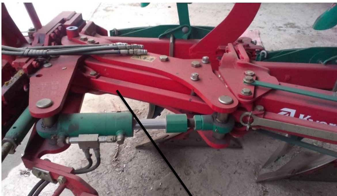
Hidravlični valj za brezstopenjsko nastavljanje delovne širine oranja
