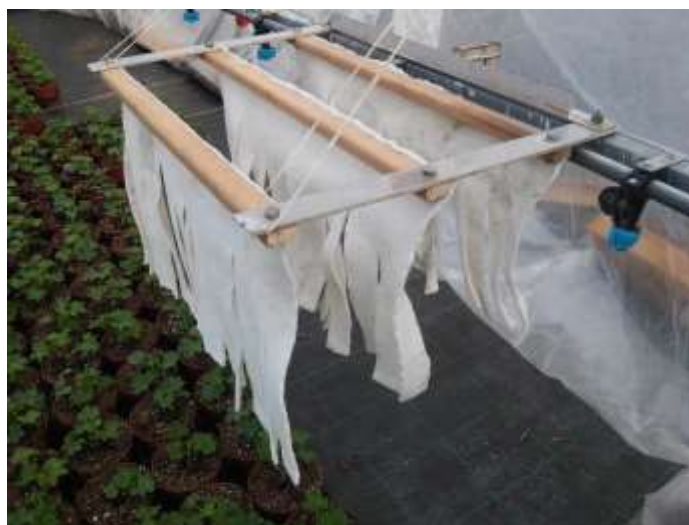
Slika 9: Trivrstno zaporedje vlaknaste tkanine, uporabljene v poskusu za izvedbo obravnavanja z mehanskimi dražljaji
