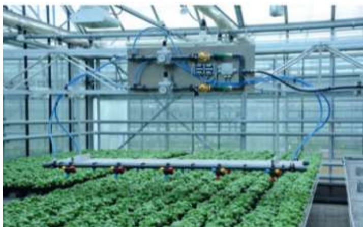
Slika 7: Prototip kompresijske rampe na LVG Heidelberg uporabljen pri poskusu na bazilikah (Wegscheider, 2015)
