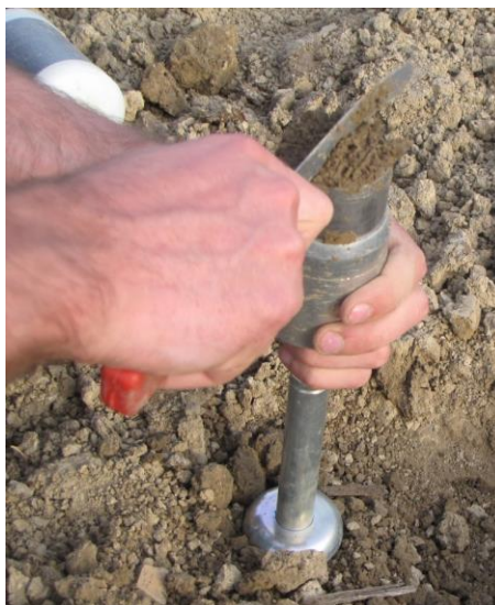
Slika 14: Odvzem vzorcev s Kopeckým cilindrom (foto: Starič, 2013)
