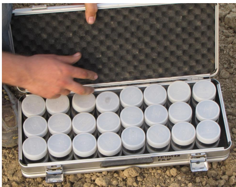
Slika 15: Vzorci zemlje v Kupeckych cilindrih (foto: Starič, 2013)
