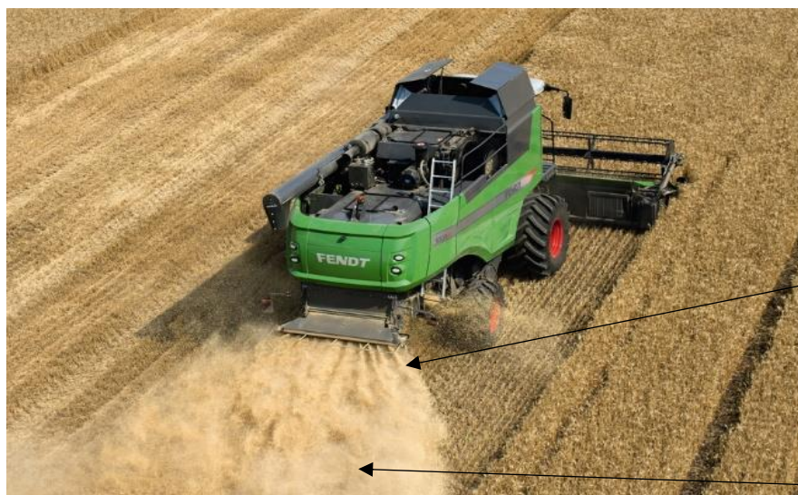
Slika 11: Odvod slame skozi slamoreznico v repu žetvenika (Interexport ..., 2016)
