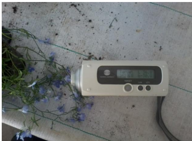
Slika 8: Merjenje barve cvetov lobelije s kolorimetrom.
