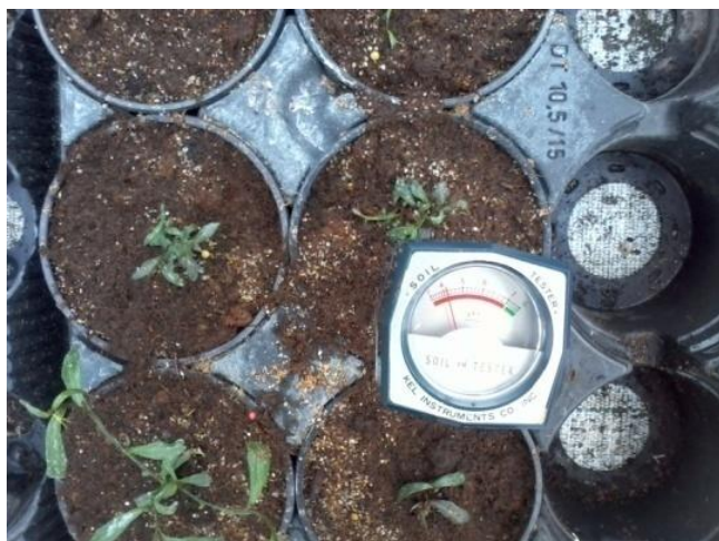
Slika 9: Merjenje pH vrednosti v različnih variantah substrata s hitrim pH metrom.
