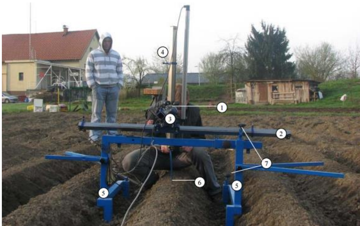
Slika 19: Koordinatna merilna naprava pri meritvi v Zaborštu v letu 2009. 1.) križni voziček, 2.) prečno vodilo, 3.) vzdolžno vodilo, 4.) navpično vodilo, 5.) ogrodje, 6.) tipalna konica, 7.) vretena za nastavitev lege naprave (Vučajnk, 2009)
