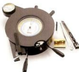
Slika 23: Fraktometer, A – za ugotavljanje lomne trdnosti pri upogibu; B – za ugotavljanje lomne trdnosti pri upogibu in pritisku; C – aparat, ki izpiše rezultate elektronske meritve lomne trdnosti pri upogibu in pritisku (IML ..., 2010)
