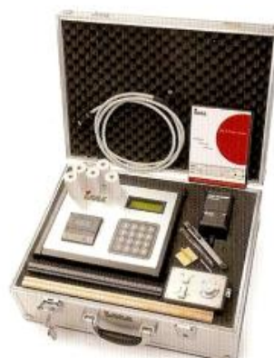
Slika 23: Fraktometer, A – za ugotavljanje lomne trdnosti pri upogibu; B – za ugotavljanje lomne trdnosti pri upogibu in pritisku; C – aparat, ki izpiše rezultate elektronske meritve lomne trdnosti pri upogibu in pritisku (IML ..., 2010)
