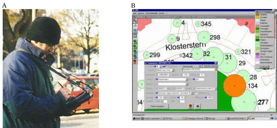
Slika 32: Izdelava Hamburškega katastra urbane drevnine, A – popisovalec z velikim vodotesnim dlančnikom; B – primer vnosa podatkov v računalniški program (Das digitale ..., 2005)
