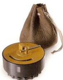
Slika 23: Fraktometer, A – za ugotavljanje lomne trdnosti pri upogibu; B – za ugotavljanje lomne trdnosti pri upogibu in pritisku; C – aparat, ki izpiše rezultate elektronske meritve lomne trdnosti pri upogibu in pritisku (IML ..., 2010)
