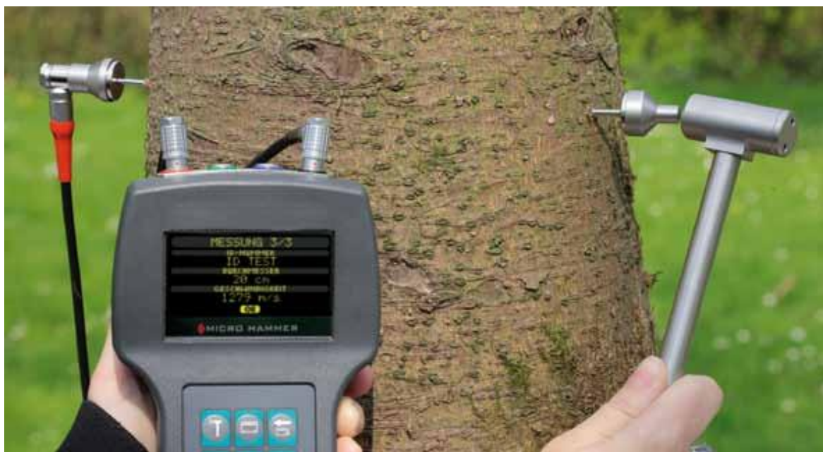
Slika 21: Primer uporabe impulznega kladiva (IML ..., 2013)
