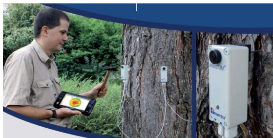
Slika 22: Arbotom 3-D imouzltomograf podjetja Rinntech; A – namestitev senzorjev, B – grafično poročilo (ARBOTOM ® ..., 2013)
