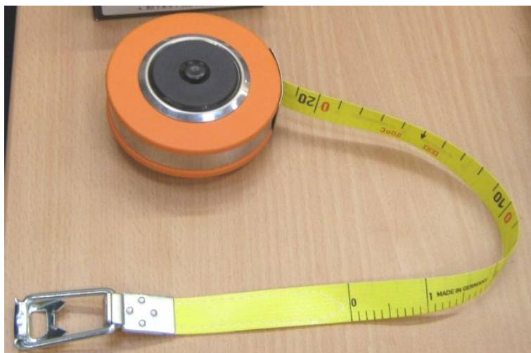
Slika 15: Merilni trak za merjenje obsega debla. Na eni strani je centimetrsko skalo, na drugi strani je skala \Pi , iz katere že ob merjenju obsega debla odčitamo njegov premer.
