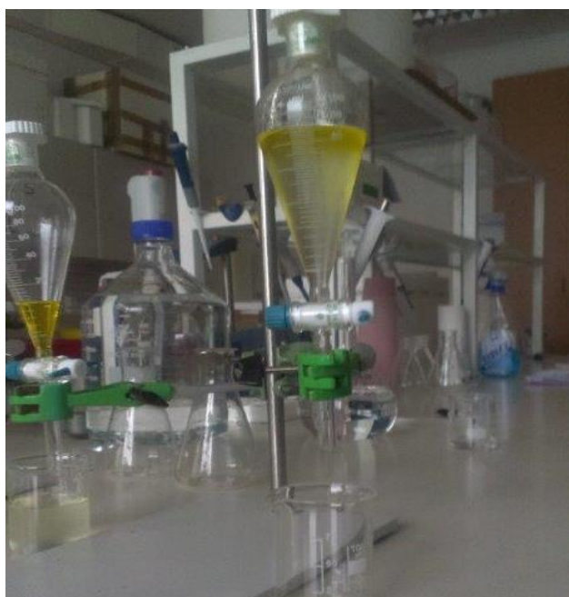
Slika 7: Spiranje heksanove faze z vodo (foto: J. Jakopič) Figure 7: Rinsing the hexane phase with water (photo: J. Jakopič)
