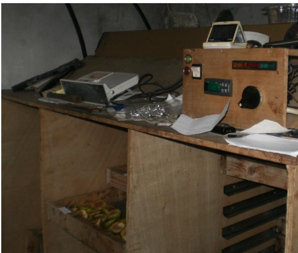
Slika 3: Sušilnica na vroč zrak. Figure 3: Hot air dryer.
