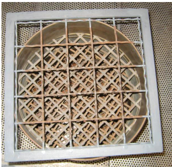
Slika 17: Sita za suho sejanje proda – v sliki je vključeno tudi sito velikosti 1 cm, ki ga v ločevanju nismo uporabili
