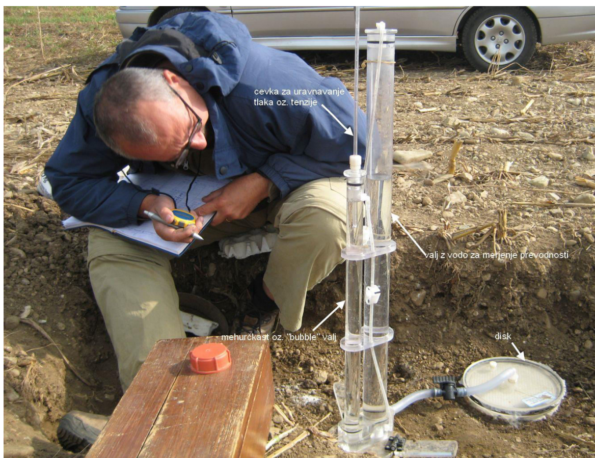
Slika 15: Tenzijski infiltrmeter Figure 15: Tension infiltrometer
