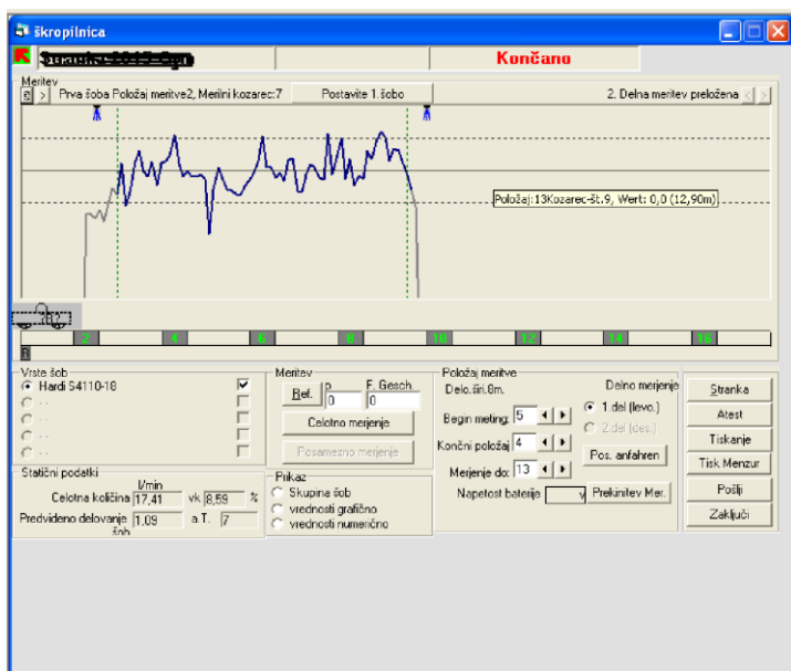
Slika 19: Primer prikaza meritev prečnega nanosa Figure 19: An example of boom sprayer cross application
