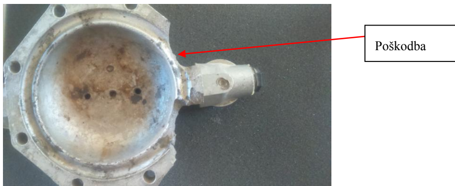
Slika 56: Počen pokrov hidravličnega blažilca Figure 56: Broken head of hydraulic shock absorber
