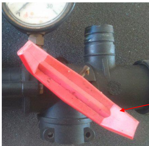
Slika 39: Zlomljena ročka za vklop in izklop Figure 39: Broken on-off handle
