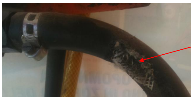
Slika 48: Poškodovana cev na letvi
