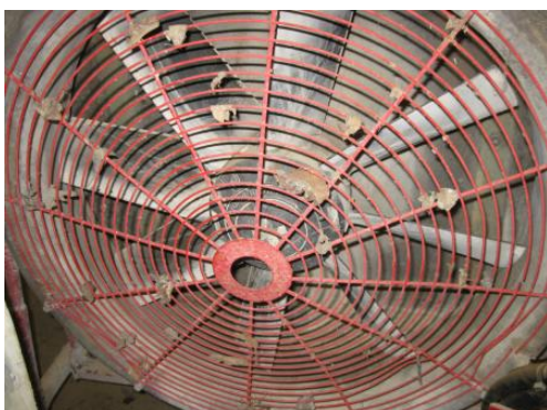
Slika 13: Puhalo z zaščitno mrežo na pršilniku Figure 13: Fan system with protective mesh on orchard sprayer
