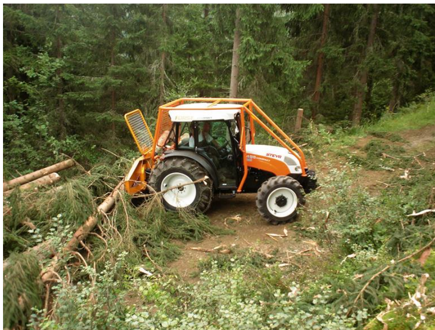
Slika 11: Traktor opremljen z vitlom in cevnim varovalnim ogradjem (Itro, 2014)
