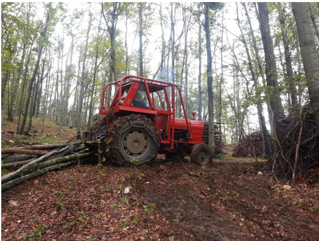
Slika 17: Prilagojen traktor za delo v gozdu s pogonom na eno os in vitlom 2 x 50 kN (foto: Blažko, 2014)
