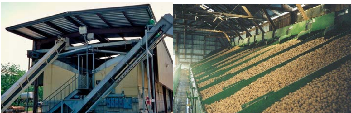
Slika 14: Zunanost in notranost sušilnice, ki ima 30° kot. V tujini jim pravijo stadion sušilnice (Thompson in sod., 2010)
