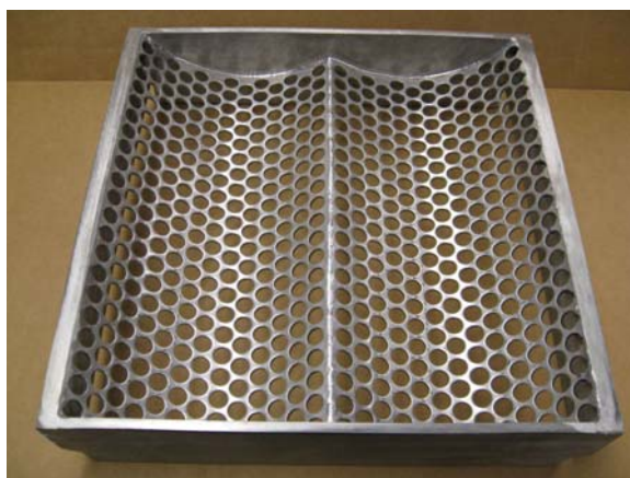
Slika 4: Primer izvedbe mrežastega sита za sortiranje velikosti jedrc (Round hole ..., 2014)
